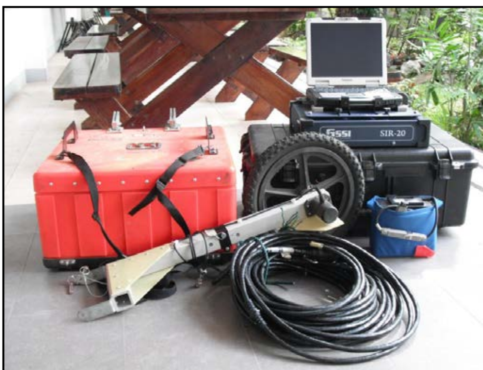
รูปที่ 3.9 แสดงเครื่องมือสำรวจธรณีเรดาร์
