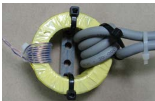
รูปที่ 3.17 ภาพหม้อแปลงไฟฟ้าแรงดันต่ำสำหรับจุดได้หลอดกำเนิดรังสีเอกซ์
