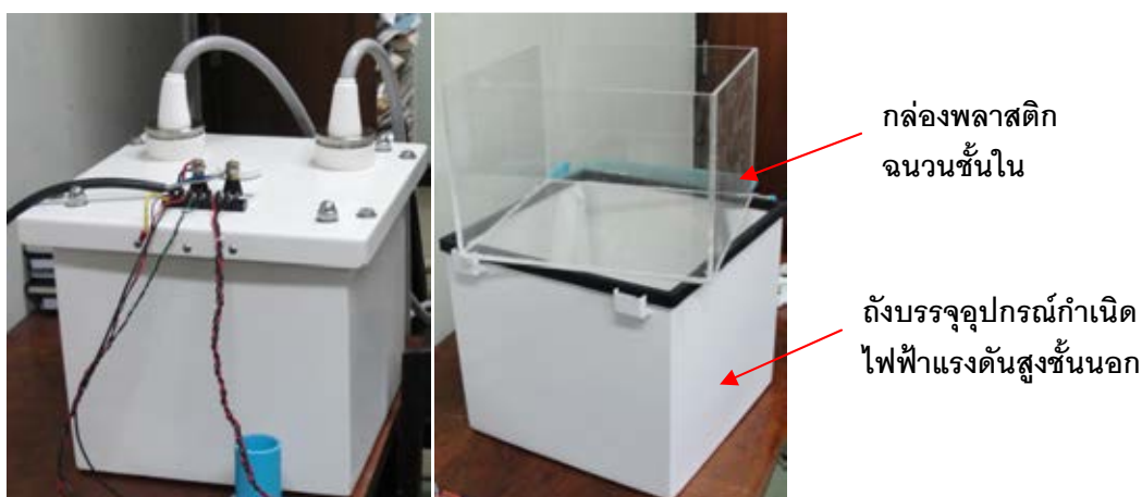
รูปที่ 3.19 ภาพถังบรรจุอุปกรณ์กำเนิดไฟฟ้าแรงดันสูงแบบฉนวนน้ำมัน
