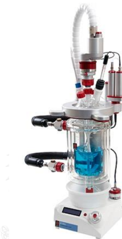
รูปที่ 23 เครื่องปฏิกรณ์ขนาด 2 ลิตร [21]
