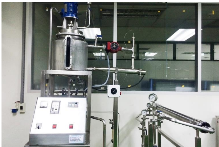
รูปที่ 24 เครื่องปฏิกรณ์ขนาด 10 ลิตร
