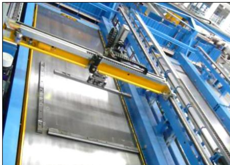
ภาพที่ 3.7 การวางเหล็กแบบกันข้างตามแนวที่กำหนด
