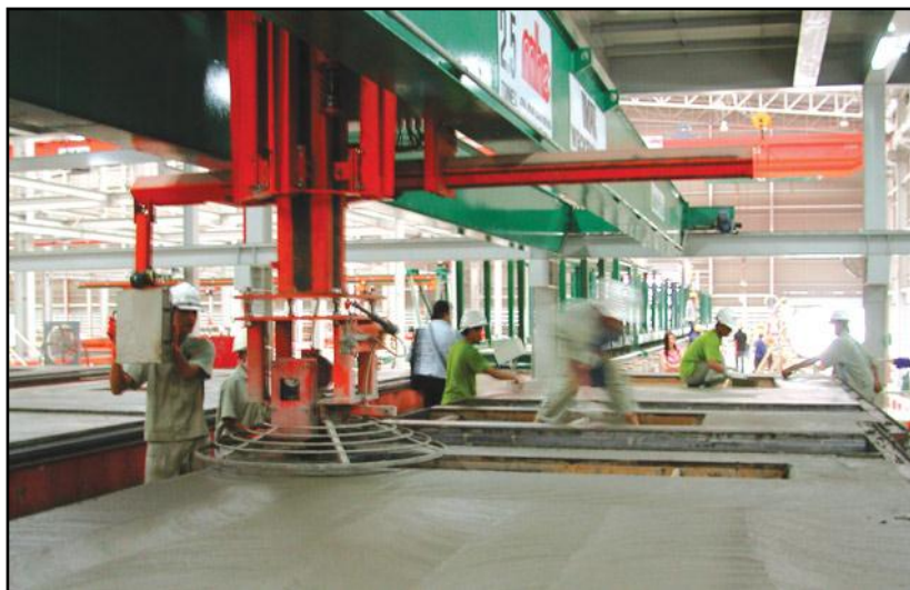
ภาพที่ 3.11 การปาดหน้าคอนกรีตด้วย Helicopter
