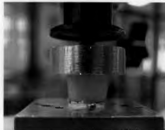
รูปที่ 87 แสดงวิธีการกดชิ้นงานหลังซีเมนต์ด้วยเครื่องคูโรมิเตอร์
