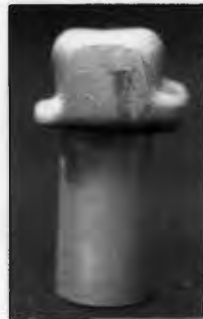
รูปที่ 59 แสดงโครงโลหะที่ออกแบบให้มีโลหะรองรับพอร์ซเลนด้านประชิดพื้นสูง 5.5 มม.
