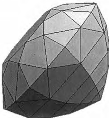
รูปที่ 5.8 เหลี่ยมขั้น (Step cut) ที่ออกแบบด้วย CU-Solid
