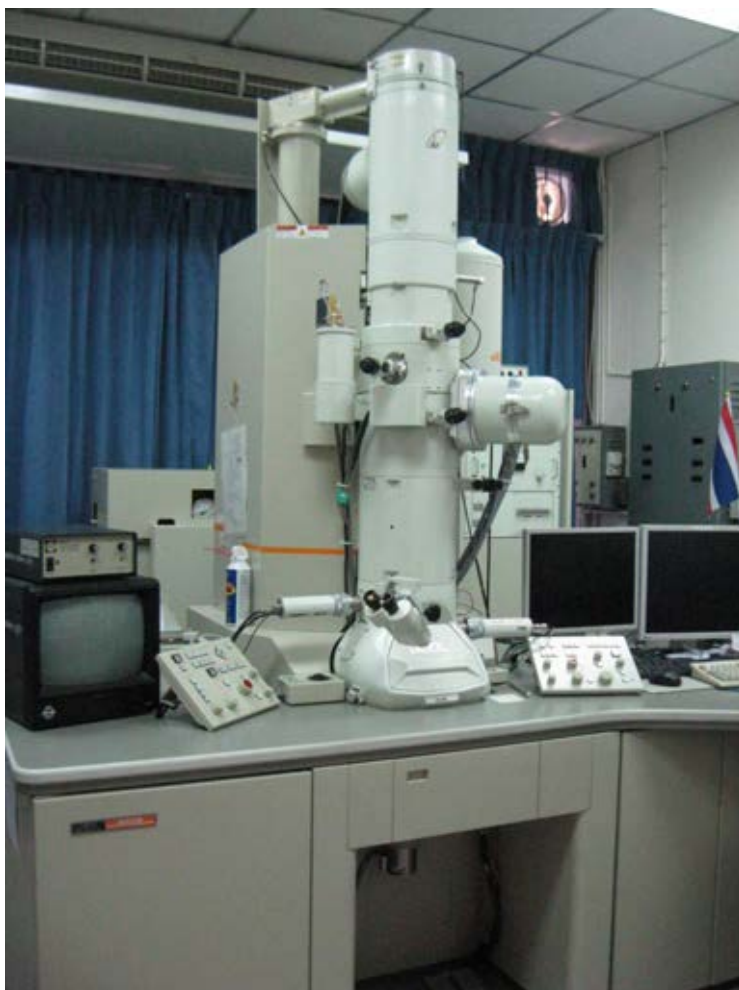
ภาพที่ 3.1 ลักษณะภายนอกของกล้องจุลทรรศน์อิเล็กตรอนชนิดส่องผ่าน (Transmission Electron Microscopy, TEM) รุ่น JEM-2100 (200KV) ผลิตโดยบริษัท JEOL, Japan
