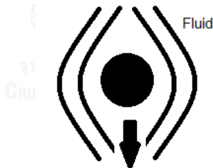
รูปที่ 7 แสดงการสะสมตัวของแอโรซอลจากแรงโน้มถ่วงช่วงที่ \text{Re} < 1 [4]
