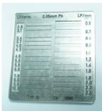
ภาพที่ 4.10 ภาพถ่าย Bar phantom
