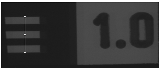
ภาพที่ 4.14 ภาพถ่ายที่กำลังขยาย 6.14 เท่าของ Bar phantom ที่ตำแหน่ง 1.0 lp/มิลลิเมตร
