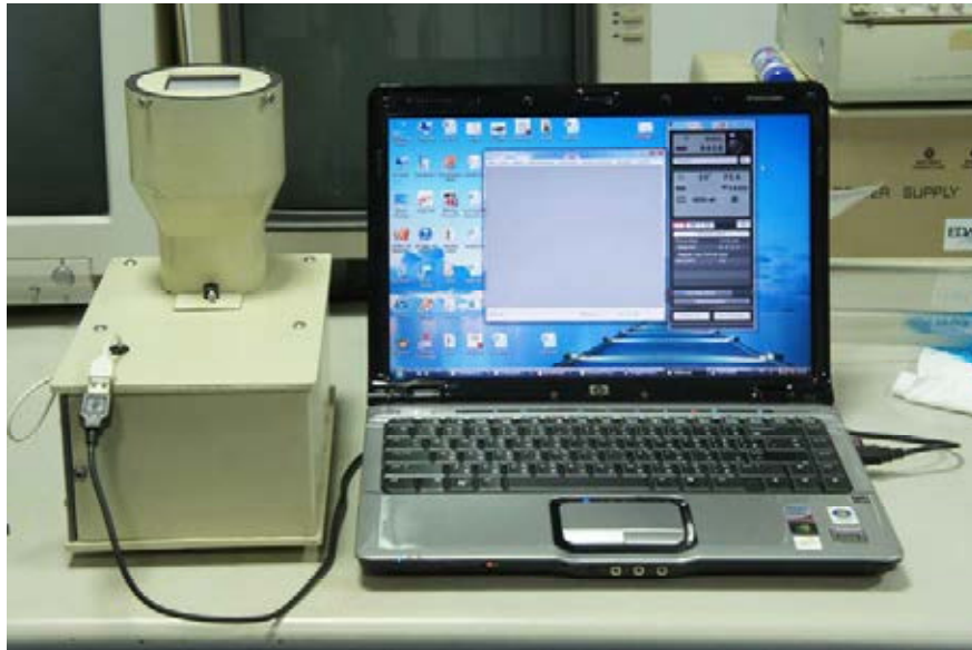
ภาพที่ 3.15 ภาพถ่ายระบบถ่ายภาพด้วยรังสีเอกซ์โดยใช้ไฟเบอร์ออปติกซินทิลเลเตอร์ ร่วมกับ กล้องดิจิตอล
