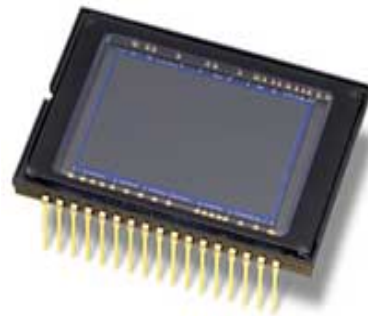
ภาพที่ 2.8 อุปกรณ์รับภาพ Charge Coupled Device (CCD) [14]
