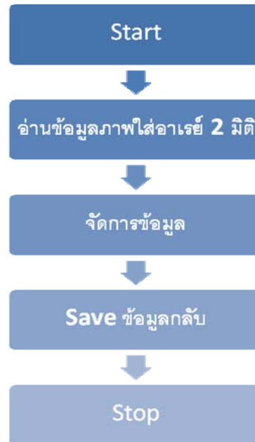
ภาพที่ 3.11 หลักการทำงานโปรแกรม DIP ในการปรับปรุงภาพดิจิทัล
