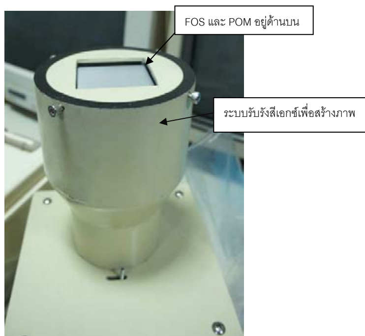
ภาพที่ 3.6 ระบบรับรังสีเอกซ์เพื่อสร้างภาพ
