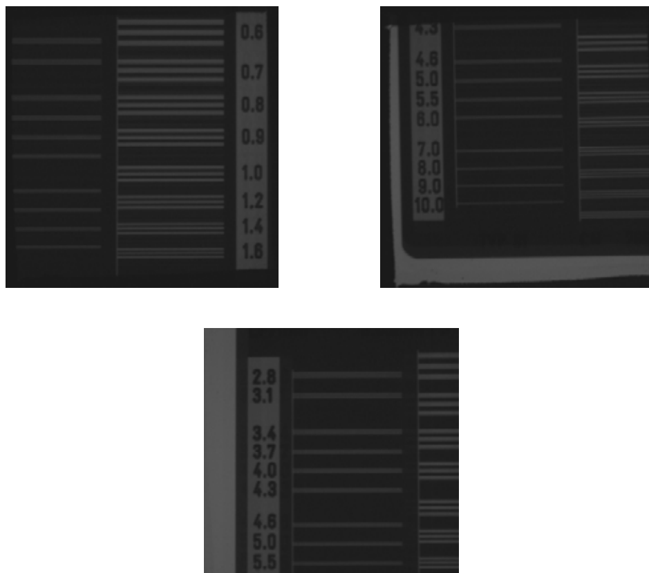
ภาพที่ 4.12 ภาพถ่ายเอกซเรย์ของ Bar phantom ที่แกน Y และแกน X
