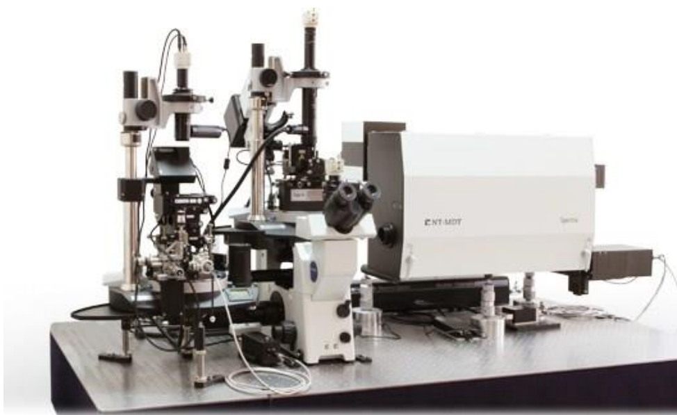
รูปที่ 3.5 เครื่องรามานสเปกโตรสโคป (ntmdt.com/afm-raman/ntegra-spectra)
