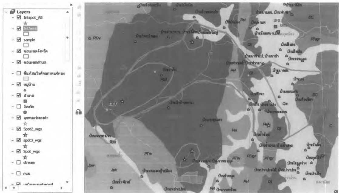
รูปที่ 3.10 แสดงการลากเส้นครอบคลุมพื้นที่ที่มีการสำรวจแหล่งแร่ (เส้นสีแดง) ซึ่งครอบคลุมพื้นที่จุดพบแร่ และพื้นที่คาดว่าจะพบแร่ด้วย
