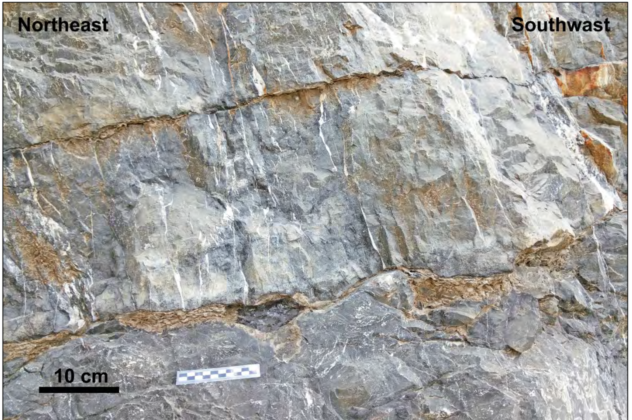
รูปที่ 4.27 ระบายรอยแตกที่เกิดจากการเคลื่อนที่ของชั้นหิน โดยเฉพาะในชั้นหินปูนที่หินดินดานแทรกจะทำให้เกิดการเลื่อนตัวตามระนาบการสะสมตัวได้ง่ายขึ้น
