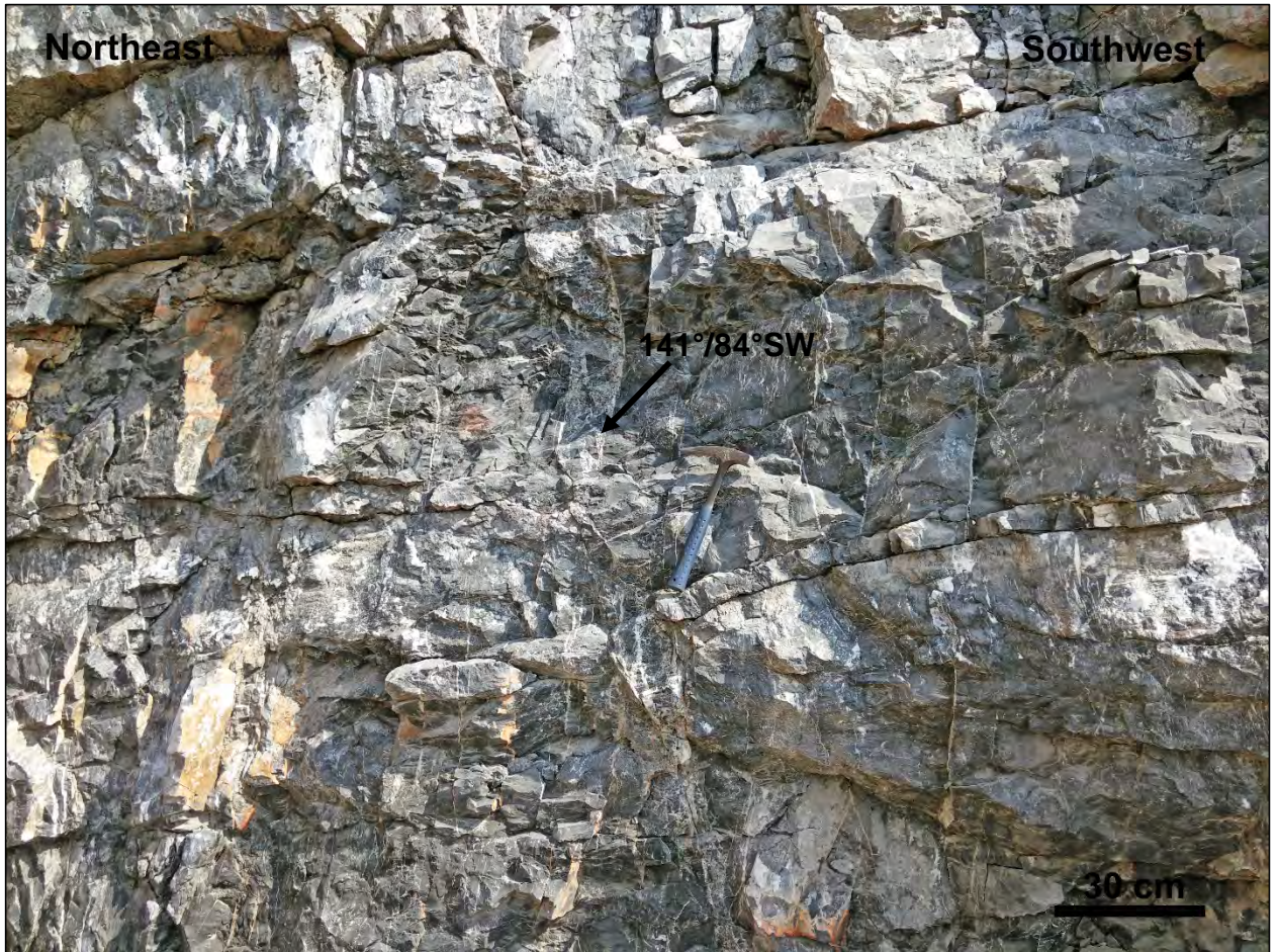
รูปที่ 4.31 ระบายรอยแตกที่มีการวางตัว 141^{\circ}/84^{\circ}\text{SW} และการแตกในแนวตั้งประกอบด้วยมีสายแร่แคลไซต์เข้ามาตกผลึกในช่องว่างรอยแตก
