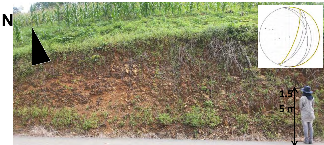
รูปที่ 20 หินโผล่ของหินดินดานแทรกสลับกับหินโคลน จุดศึกษาที่ 2 แสดงแนวแตกชัดเจนและตลอดทั้งหินโผล่แนวการวางตัวของชั้นหินอยู่ในแนวเหนือ-ใต้มีมุมเอียงเทสูงไปทางทิศตะวันออก
