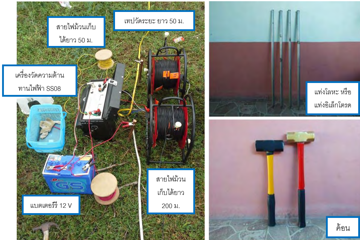
รูปที่ 3.2 อุปกรณ์การออกภาคสนามเพื่อเก็บข้อมูลความต้านทานไฟฟ้า (Resistivity)
