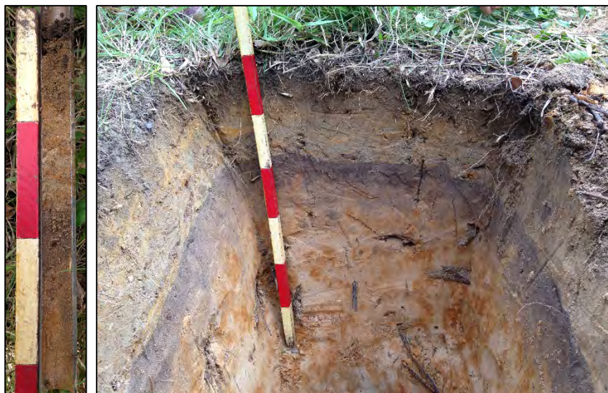
รูปที่ 3.2 แท่งตัวอย่างตะกอน (ซ้าย) และหลุมสำรวจที่ 11 (ขวา)
