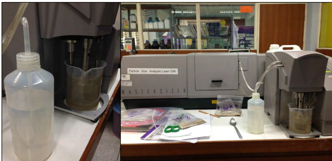
รูปที่ 2.4 เครื่องมือวิเคราะห์ขนาดตะกอน Particle Size Analyzer รุ่น Mastersizer S
