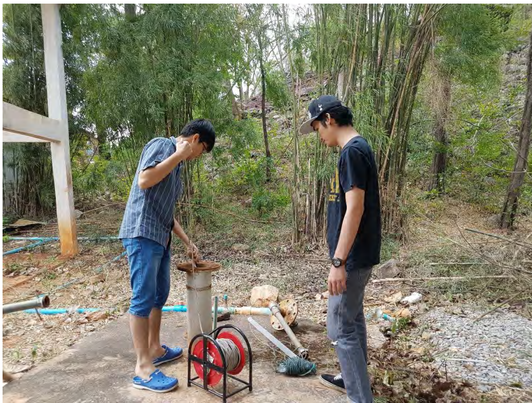
รูปที่ 3.4 การวัดระดับน้ำบาดาลด้วยเครื่องวัดระดับน้ำ
