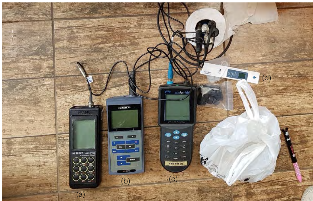
รูปที่ 3.3 เครื่องมือที่ใช้ในการออกภาคสนาม (a) Ion meter (เครื่องวัดปริมาณไนเตรท) (b) pH-ORP meter (c) DO-Temperature meter (d) EC meter
