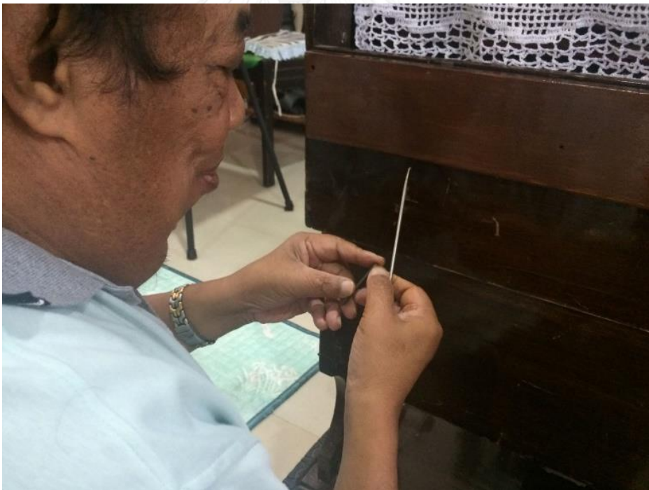
ภาพที่ 25 คุณครูประสิทธิ์ คุ้มทรัพย์แสดงวิธีการชักลิ้นออกจากเครื่องออร์แกน
