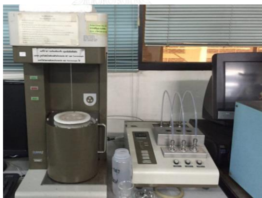
Fig 3.11 Brunauer-Emmett-Teller (BET) analyzer
