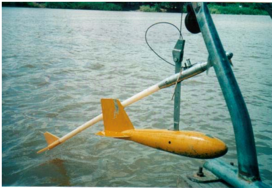
รูปที่ ข-1 การหย่อน current meter ลงไปเพื่อวัดความเร็วของกระแสน้ำ
