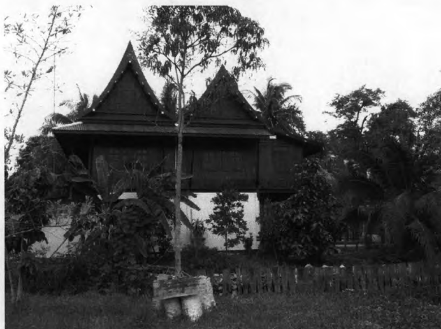
ภาพ: เรือนไทยครึ่งตึกครึ่งไม้ มีการก่ออิฐฉาบปูนใต้ถุนเรือน
