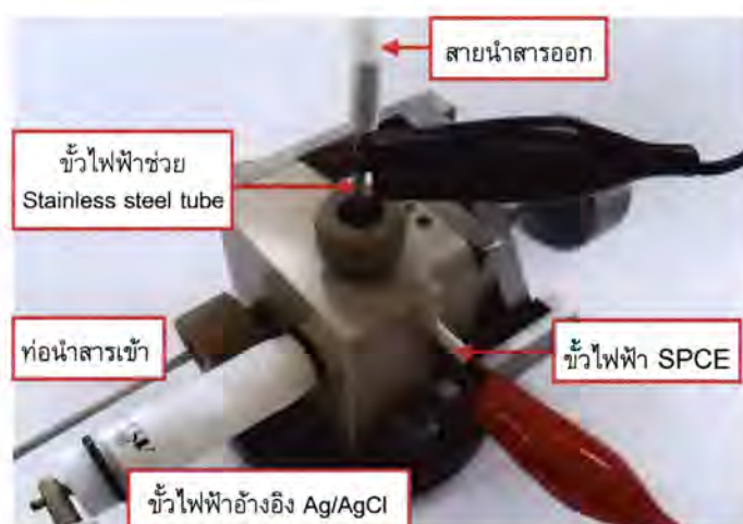
รูปที่ 16 การต่อขั้วไฟฟ้าเข้ากับโพล์เซลล์
