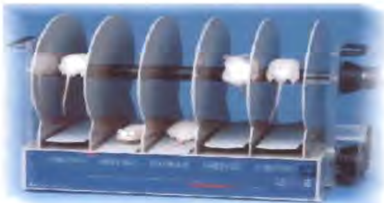
ภาพที่ 3 เครื่องมือสำหรับการทดสอบการเคลื่อนไหวและการทรงตัวของหนูเม้าส์ (Rotarod Test)
