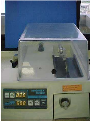
รูปที่ 5 แสดง เครื่องตัดพื้น Isomet และลักษณะการวางชิ้นงานเพื่อตัดพื้น
