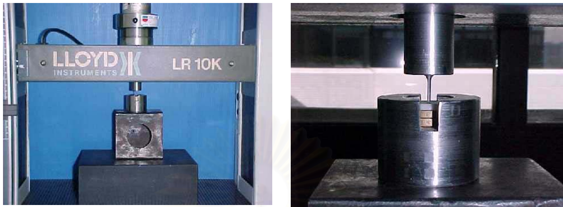
รูปที่ 11 แสดง ลักษณะของเครื่องมือแท่นยึดชิ้นงานในการทดสอบความแข็งแรงพันธะฉนวนแบบผลึกออกด้วยเครื่องลloyd
