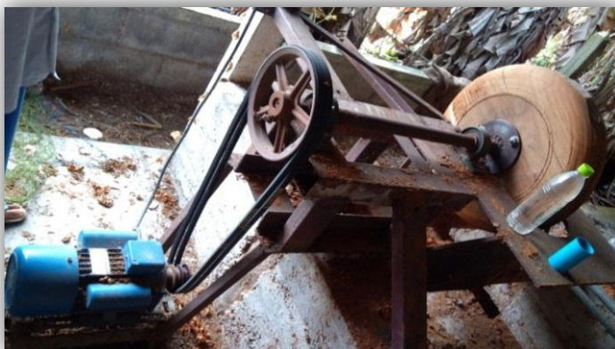
ภาพที่ 72 เมื่อกลึงทรงกลมด้านนอกเสร็จ ที่มา : สุรินทร์ โสภากาศ วันเสาร์ที่ 24 มิถุนายน 2560
