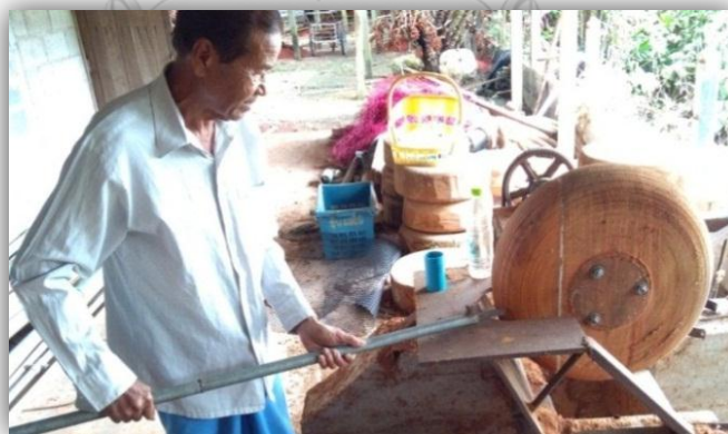
ภาพที่ 71 นำท่อนไม้ใส่เครื่องกลึงและกลึงให้ได้ทรงตามที่กำหนด ที่มา : สุรินทร์ โสภากาศ วันเสาร์ที่ 24 มิถุนายน 2560
