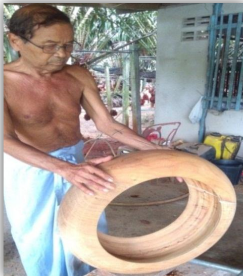
ภาพที่ 75 หุ่นรำมะนาลำตัดเมื่อกลึงเสร็จแล้วขัดกระดาษทราย ที่มา : สุรินทร์ โสภากาศ วันพุธที่ 30 มิถุนายน 2560
