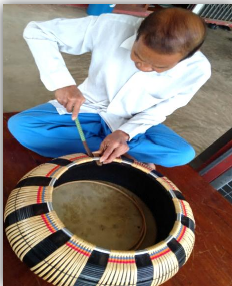
ภาพที่ 81 การนำท่อนไม้ชิ้นเล็กทรงสามเหลี่ยมมาสอดลงไปด้านหลังกลองเพื่อตั้งเหล็กให้ตั้ง ที่มา : สุธินันท์ โสภากาศ วันเสาร์ที่ 24 มิถุนายน 2560
