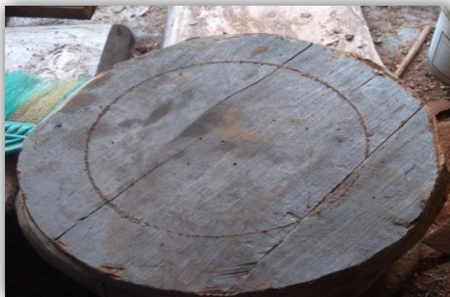
ภาพที่ 70 การวัดขนาดท่อนไม้ก่อนนำเข้าเครื่องกลึง ที่มา : สุรินทร์ โสภากาศ วันเสาร์ที่ 24 มิถุนายน 2560
