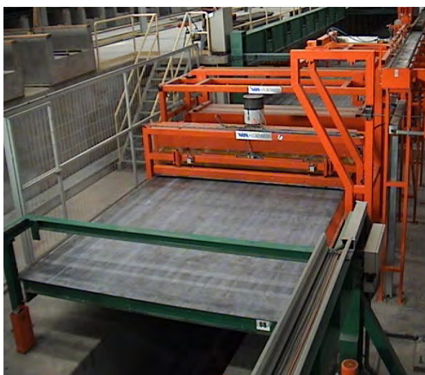
รูปที่ 3.19 ขั้นตอนการทำความสะอาด เคลือบน้ำมันโต๊ะหล่อ
