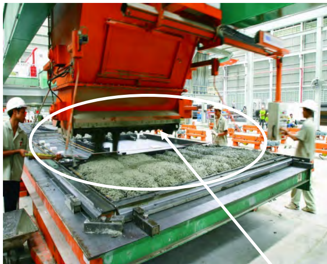
เทคอนกรีต
