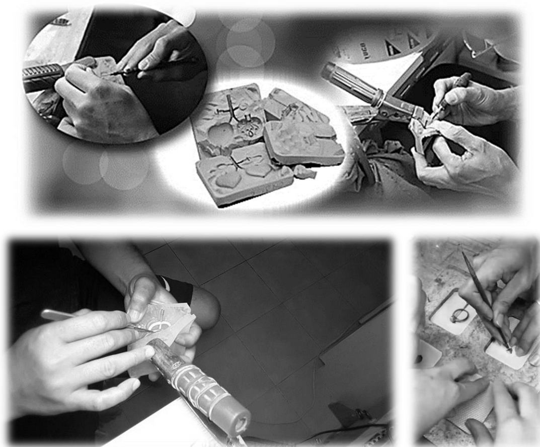
รูปที่ 7.74 การทำพิมพ์ยาง
