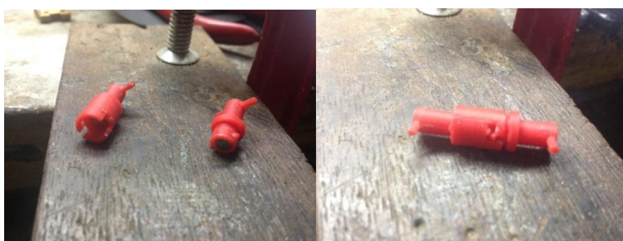
รูปที่ 7.50 ชุดข้อต่อแบบล็อคต้นแบบที่ฝังแม่เหล็กไว้ภายในสามารถใช้งานได้ดียังสามารถดูติดกัน ได้อย่างแน่นหนา
