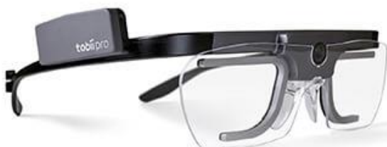
รูปที่ 2.3 เครื่องมือติดตามการมองที่ต้องสวมใส่กับร่างกายมนุษย์ (Tobii Pro Glasses) ที่มา: www.tobii.com
