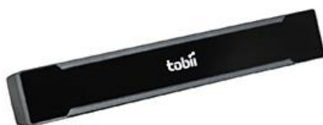
รูปที่ 2.4 เครื่องมือติดตามการมองที่ไม่ต้องเชื่อมต่อกับร่างกายมนุษย์ (Tobii Pro X2-30) ที่มา: www.tobii.com
