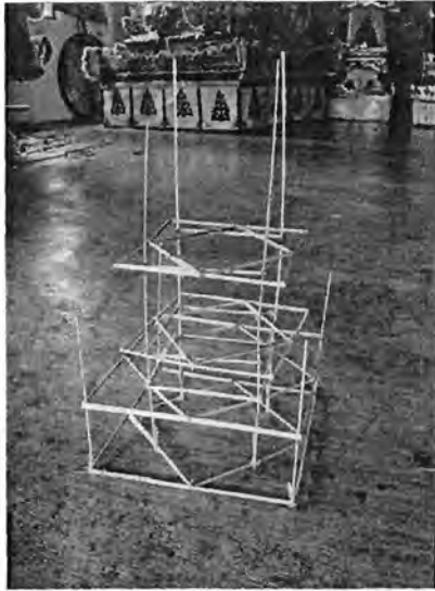
ภาพที่ ๑.๒.๔๔ โครงสร้างจองพารา ทำจากไม้ไผ่
