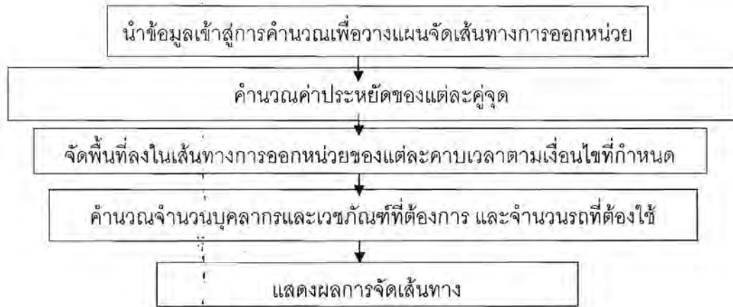
รูปที่ 14 ขั้นตอนการคำนวณประมวลผลจัดเส้นทางการออกหน่วยของการให้บริการแบบต่อเนื่อง
