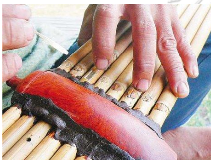
ภาพที่ 13 การใช้ซี่สุดเพื่ออุดรอยรั่วของไม้
