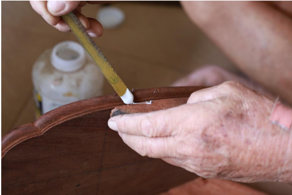
ภาพที่ 4.61 ครูชลอ ใจชื่น อัดกาวเพื่อประกอบรางระนาดเอกเข้ากับโขนระนาดเอก ที่มา : วุฒิพงศ์ เถาลัดดา บันทึกภาพวันที่ 27 พฤษภาคม 2561
