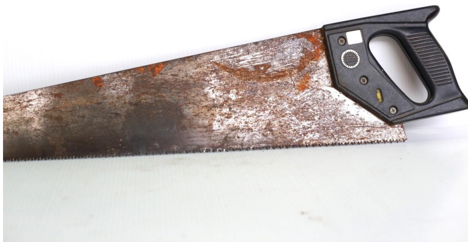
ภาพที่ 4.21 เลื่อยลันดา ที่มา : วุฒิพงศ์ เถาลัดดา บันทึกภาพวันที่ 10 เมษายน 2561
