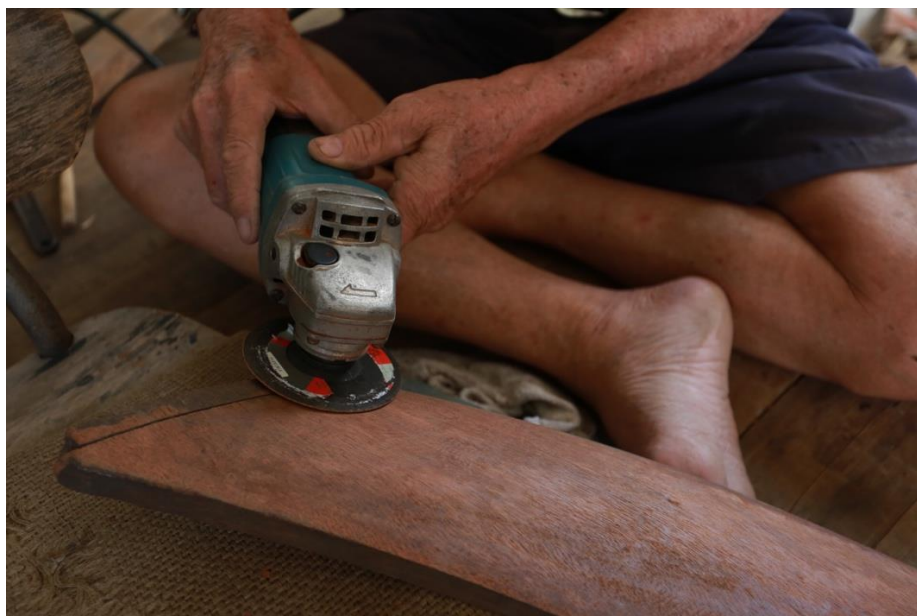
ภาพที่ 4.48 ครูชลอ ใจชื่น ใช้ลูกหมูแต่งด้านหน้ารางระนาดเอก ที่มา : วุฒิพงศ์ เถาลัดดา บันทึกภาพวันที่ 12 พฤษภาคม 2561
