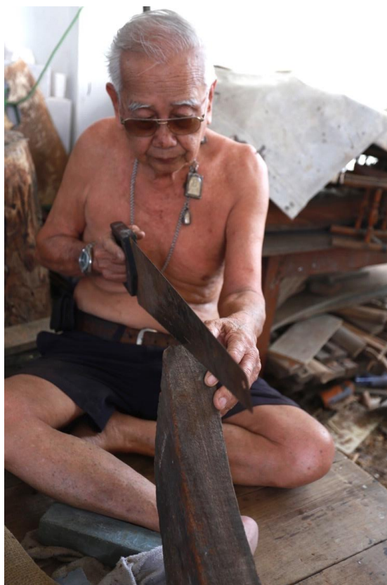
ภาพที่ 4.45 ครูชลอ ใจชื่น ใช้เลื่อยไม้ เลื่อยรางระนาดเอก
