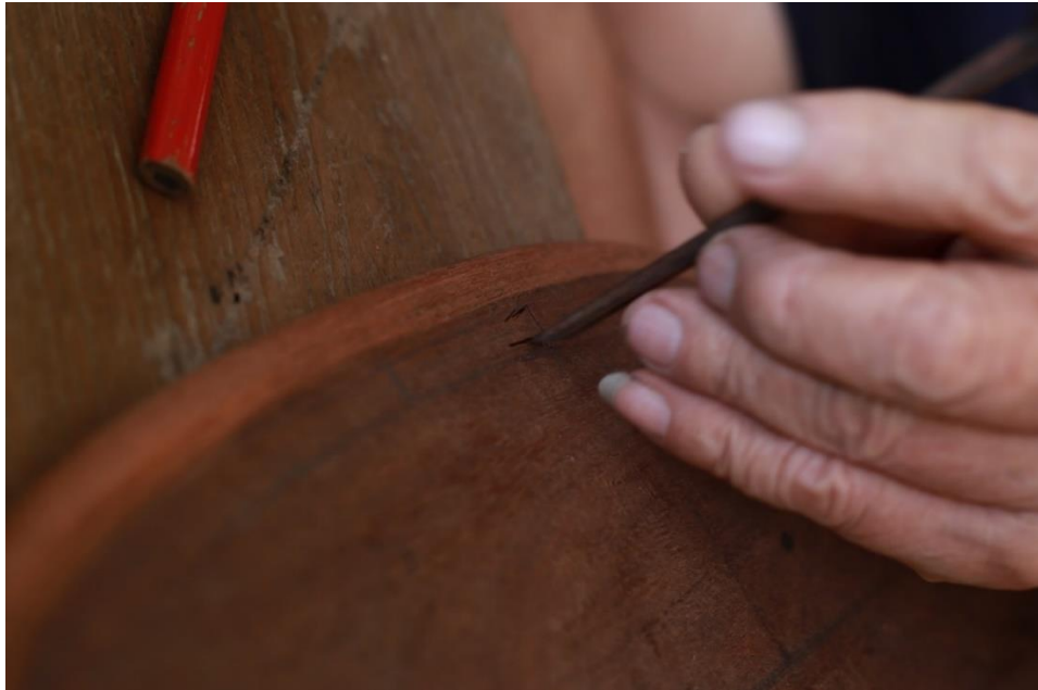
ภาพที่ 4.56 ครูชลอ ใจชื่น ใช้ส่วขนาดเล็กทำเดือยโขนขนาดเอก ที่มา : วุฒิพงศ์ เถาลัดดา บันทึกภาพวันที่ 19 พฤษภาคม 2561
