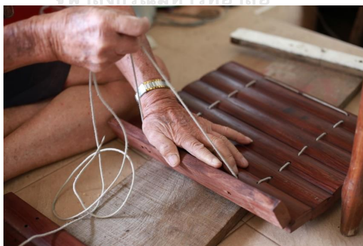
ภาพที่ 4.103 ครูชลอ ใจชื่น ร้อยเชือกฝืนระนาบเอก ที่มา : วุฒิพงศ์ เถาลัดดา บันทึกภาพวันที่ 8 กรกฎาคม 2561
