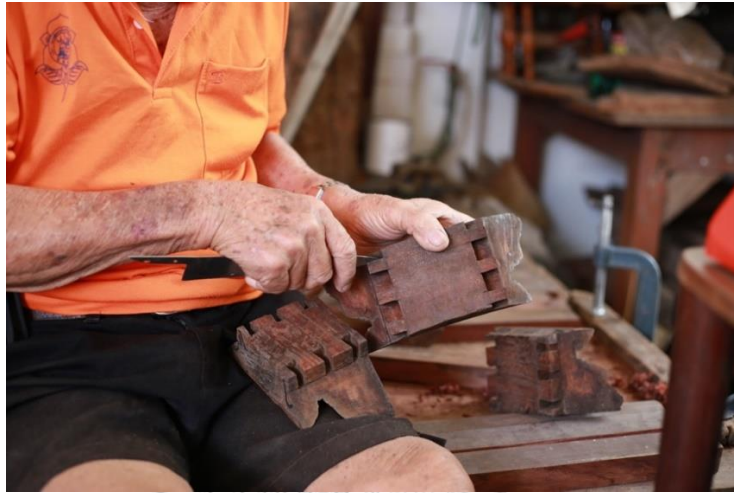
ภาพที่ 4.74 การใช้มีดปลายแหลมแต่งเดือยเท้าระนาดเอก ที่มา : วุฒิพงศ์ เถาลัดดา บันทึกภาพวันที่ 2 มิถุนายน 2561
