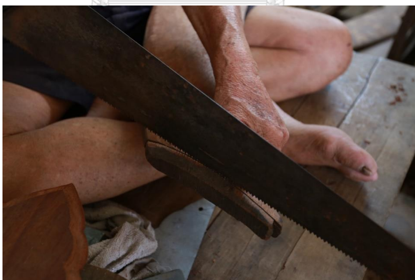
ภาพที่ 4.50 ครูชลอ ใจชื่น ใช้เลื่อยตัดไม้ตัดส่วนขอบวางขนาดเอก ที่มา : วุฒิพงศ์ เถาลัดดา บันทึกภาพวันที่ 19 พฤษภาคม 2561
