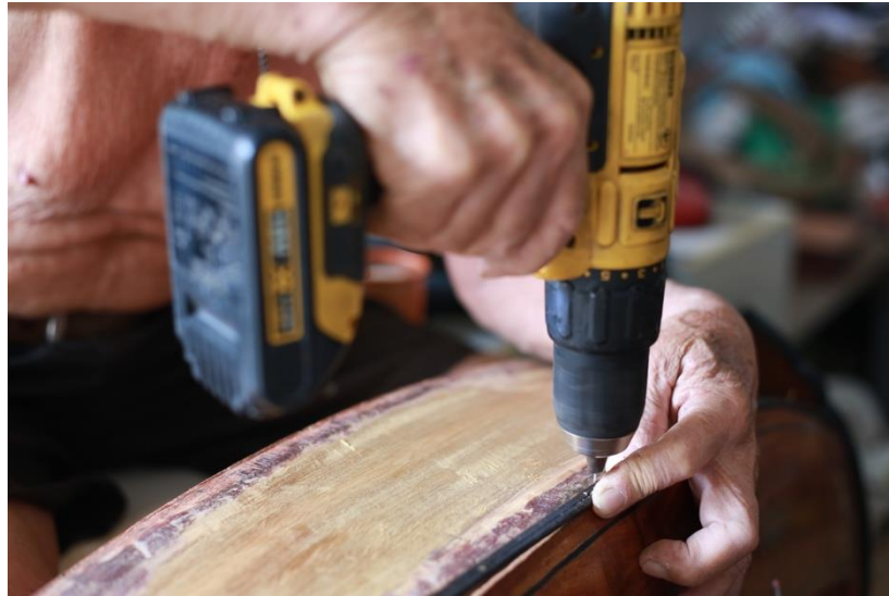
ภาพที่ 4.68 ครูชลอ ใจชื่น ใช้สว่านเจาะรูเพื่อประกอบค้ำระนาดเอก ที่มา : วุฒิพงศ์ เถาลัดดา บันทึกภาพวันที่ 16 กันยายน 2561
