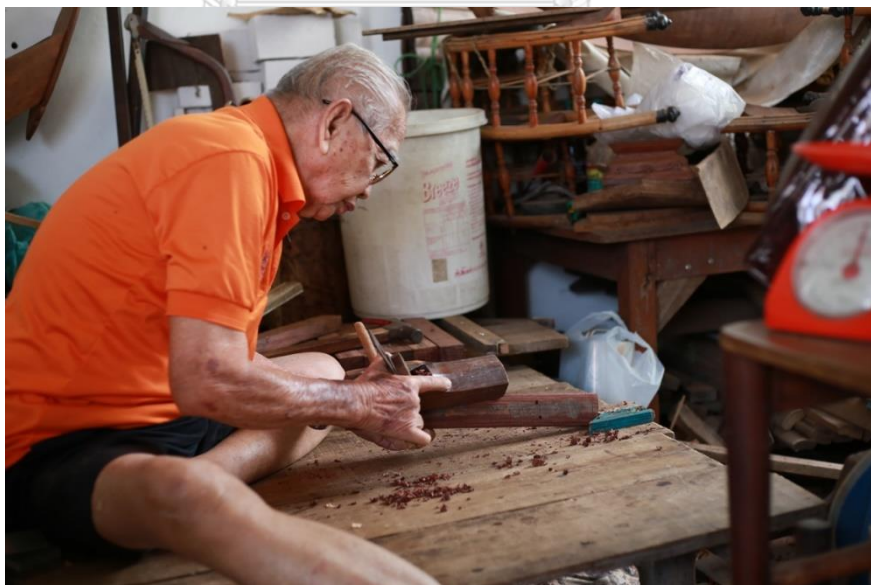
ภาพที่ 4.100 ครูชลอ ใจชื่น ใช้กบไสไม้แต่งฝืนระนาดเอกด้านบน
