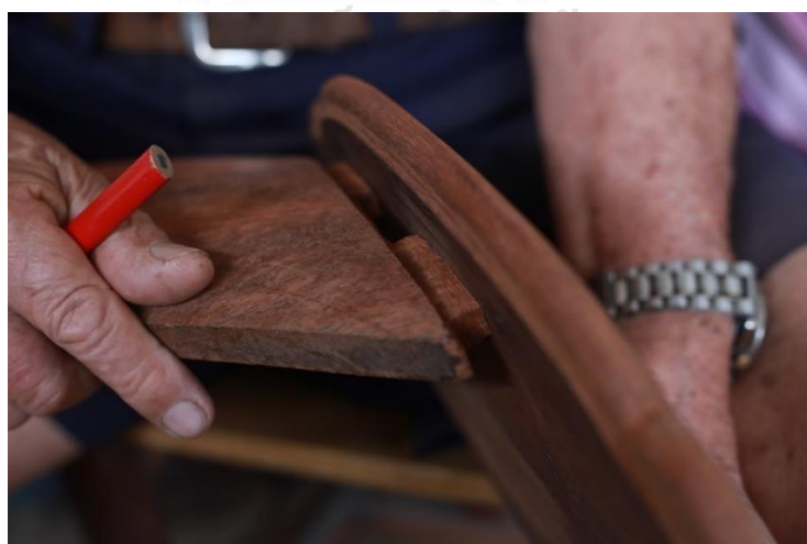
ภาพที่ 4.60 ครูชลอ ใจชื่น ทดสอบทาบเดียวรางรางระนาดเอกเข้ากับรูดเดียวไขนระนาดเอก ที่มา : วุฒิพงศ์ เถาลัดดา บันทึกภาพวันที่ 19 พฤษภาคม 2561
