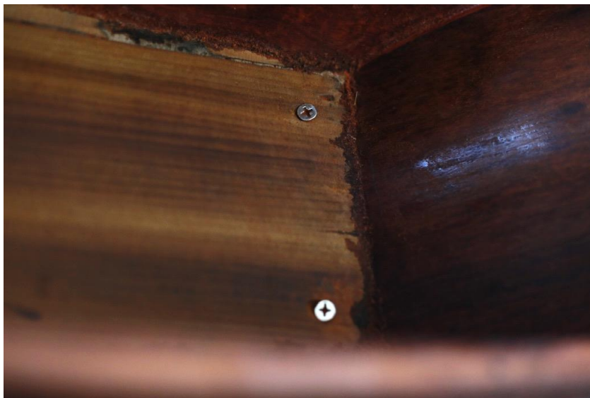
ภาพที่ 4.64 ตะปูคองที่ใช้ไขประกอบท้องระนาดเอกเข้ากับกับรางระนาดเอก
