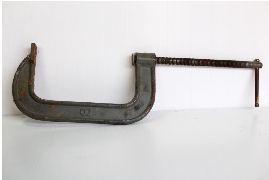
ภาพที่ 4.26 ปากการัดไม้รูปตัวซี 4 นิ้ว ที่มา : วุฒิพงศ์ เถาลัดดา บันทึกภาพวันที่ 10 เมษายน 2561
