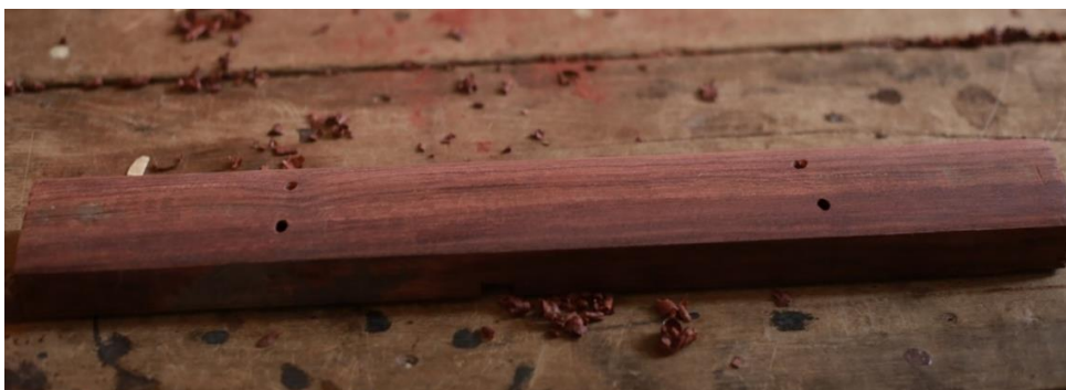
ภาพที่ 4.102 ครูชลอ ใจชื่น ลูกระนาดเอกด้านบนที่ผ่านการไสเรียบร้อย ที่มา : วุฒิพงศ์ เถาลัดดา บันทึกภาพวันที่ 16 มิถุนายน 2561
