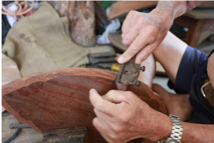
ภาพที่ 4.40 ครูชลอ ใจชื่น ใช้กับเหล็กไสไม้บริเวณโดยรอบขอบโขนระนาดเอก ที่มา : วุฒิพงศ์ เถาลัดดา บันทึกภาพวันที่ 5 พฤษภาคม 2561
