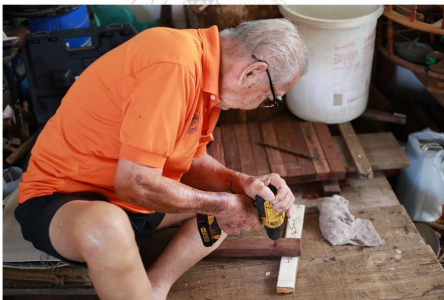
ภาพที่ 4.99 ครูชลอ ใจชื้น เจาะรูร้อยเชือกฝืนระนาดเอก ที่มา : วุฒิพงศ์ เถาลัดดา บันทึกภาพวันที่ 16 มิถุนายน 2561
