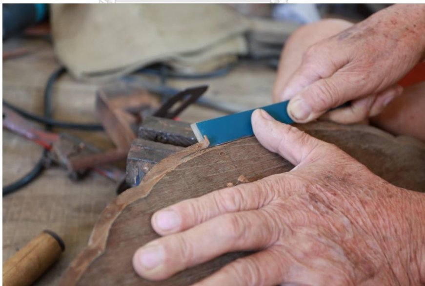
ภาพที่ 4.39 ครูชลอ ใจชื่น ใช้เลื่อยตัดเหล็กเซาะโขนระนาดเอก ที่มา : วุฒิพงษ์ เถาลัดดา บันทึกภาพวันที่ 5 พฤษภาคม 2561
