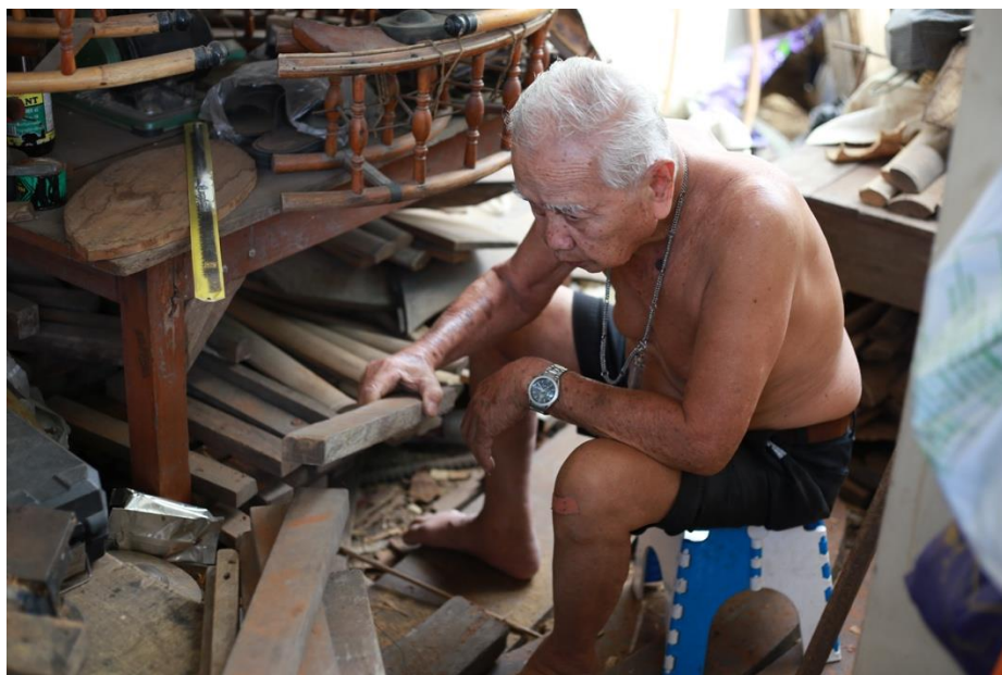
ภาพที่ 4.93 ครูชลอ ใจชื่น เลือกไม้ชิงชันเพื่อทำผืนระนาดเอก ที่มา : วุฒิพงศ์ เถาถัดดา บันทึกภาพวันที่ 27 พฤษภาคม 2561
