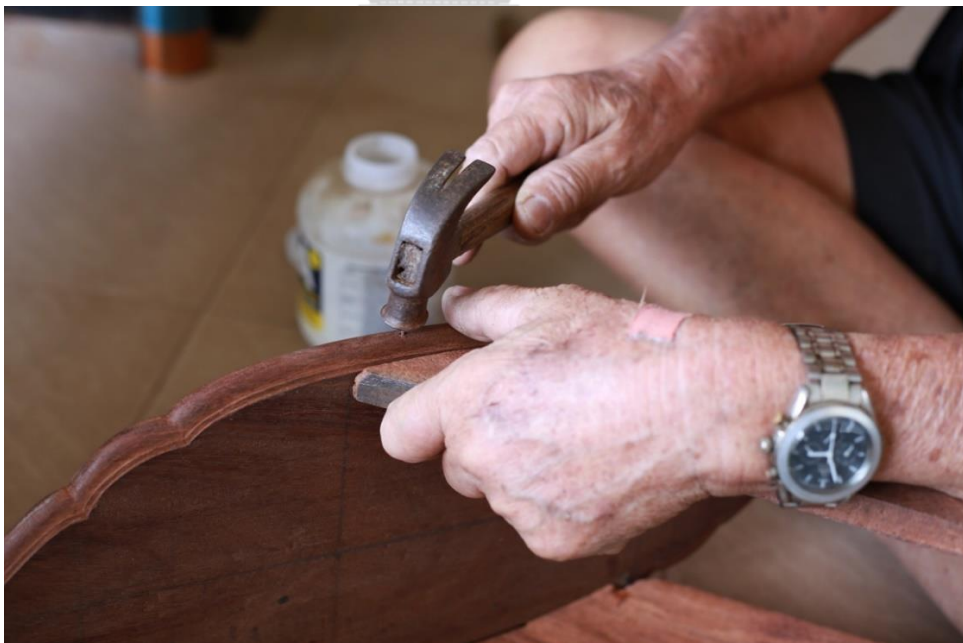
ภาพที่ 4.62 ครูชลอ ใจชื่น ตอกตะปูเพื่อประกอบรางระนาดเอกเข้ากับโขนระนาดเอก ที่มา : วุฒิพงศ์ เถาลัดดา บันทึกภาพวันที่ 27 พฤษภาคม 2561
