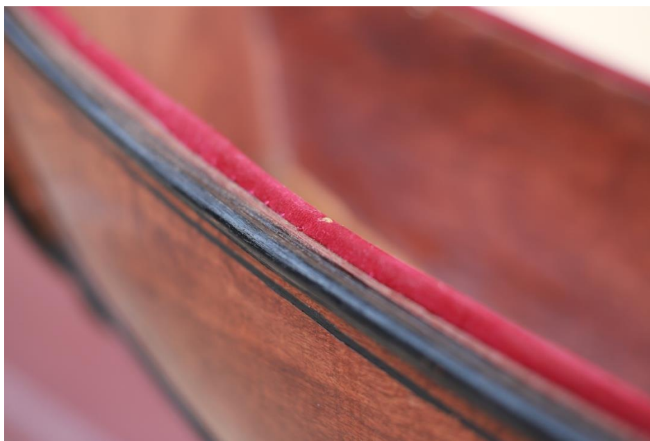
ภาพที่ 4.90 ครูชลอ ใจชื่น เย็บกำมะหยี่เข้ากับหวาย ที่มา : วุฒิพงศ์ เถาลัดดา บันทึกภาพวันที่ 30 กันยายน 2561 CHULALONGKORN UNIVERSITY
