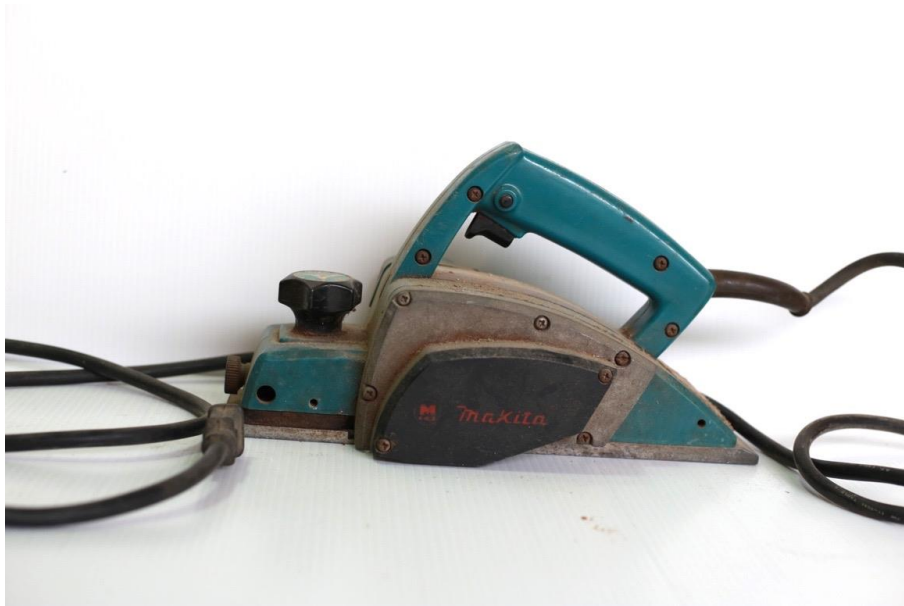
ภาพที่ 4.20 กบไฟฟ้า ที่มา : วุฒิพงศ์ เถาลัดดา บันทึกภาพวันที่ 10 เมษายน 2561
