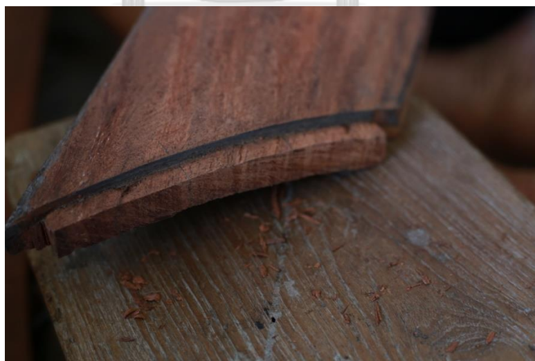
ภาพที่ 4.51 ขอบรางขนาดเอกเมื่อใช้เลื่อยตัดแล้ว
