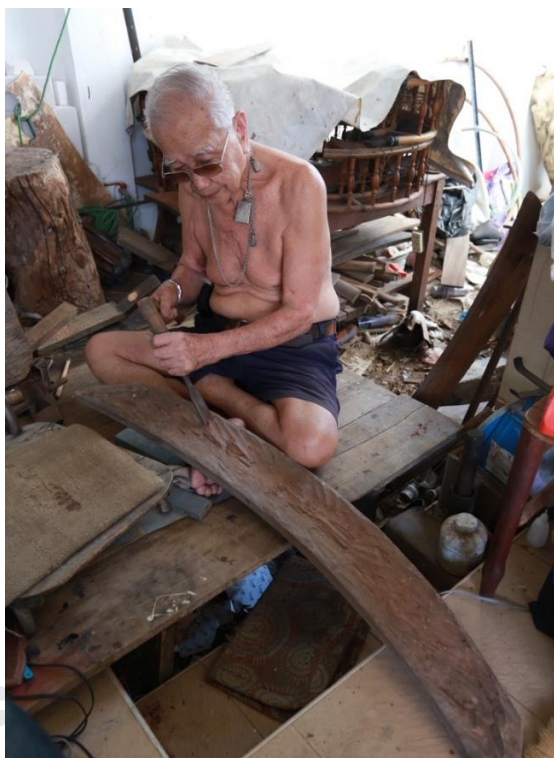
ภาพที่ 4.47 ครูชลอ ใจชื่น ใช้ลีวแต่งรางระนาดเอก ที่มา : วุฒิพงษ์ เก้าลัดดา บันทึกภาพวันที่ 12 พฤษภาคม 2561
