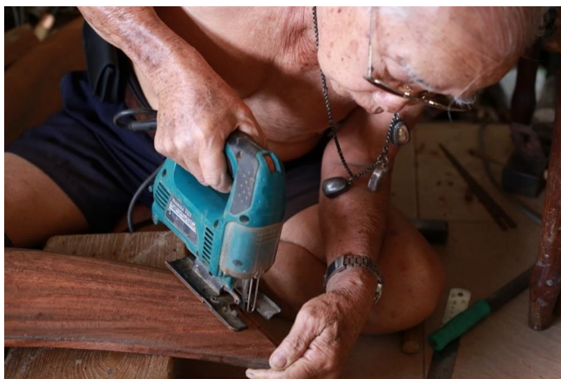
ภาพที่ 4.52 ครูชลอ ใจชื่น ใช้เลื่อยจิ๊กซอว์ตัดขอบรางขนาดเอกเพื่อทำเดือย ที่มา : วุฒิพงศ์ เถาลัดดา บันทึกภาพวันที่ 19 พฤษภาคม 2561
