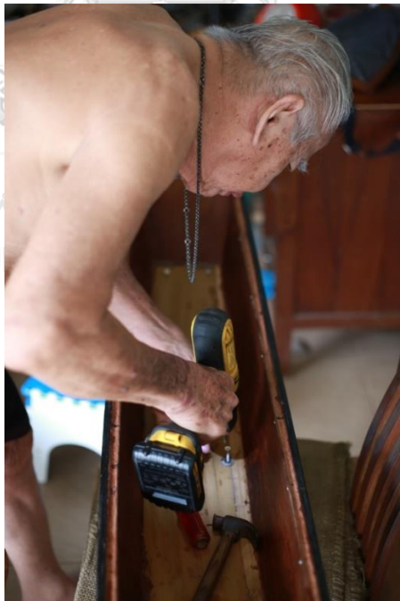
ภาพที่ 4.87 ครูชลอ ใจชื่น ประกอบเท้าระนาดเอกเข้ากับรางระนาดเอก ที่มา : วุฒิพงศ์ เถาลัดดา บันทึกภาพวันที่ 22 กันยายน 2561
