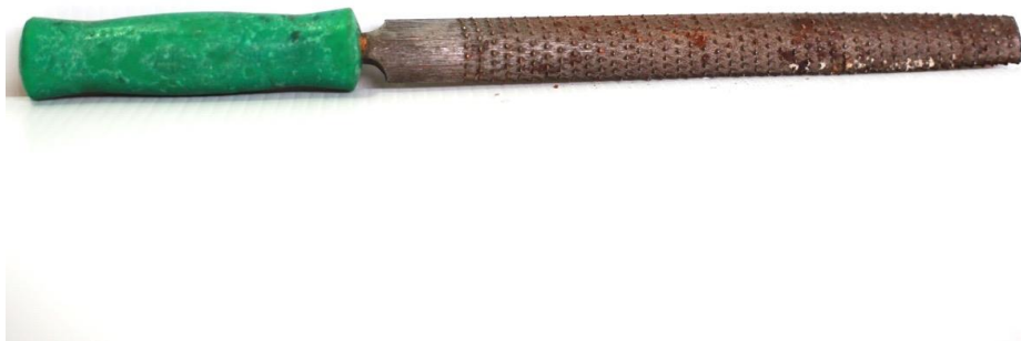
ภาพที่ 4.7 ตะไบบั้ง ที่มา : วุฒิพงศ์ เถาวัลย์ดา บันทึกภาพวันที่ 10 เมษายน 2561
