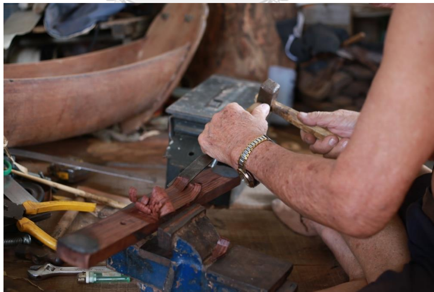
ภาพที่ 4.111 ครูชลอ ใจชื่น ใช้ค้อนและสิ่วบากห้องฝืนขนาดเอก ที่มา : วุฒิพงศ์ เถาลัดดา บันทึกภาพวันที่ 8 กรกฎาคม 2561
