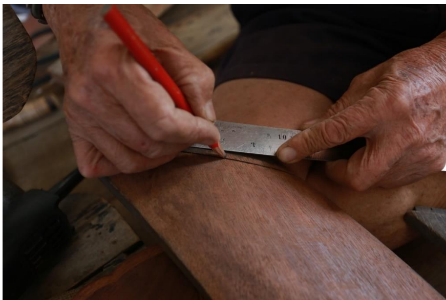
ภาพที่ 4.49 ครูชลอ ใจชื่น ใช้ไม้บรรทัดวัดเพื่อให้ดินสอขีดเส้นวางขนาดเอก ที่มา : วุฒิพงศ์ เถาลัดดา บันทึกภาพวันที่ 19 พฤษภาคม 2561
