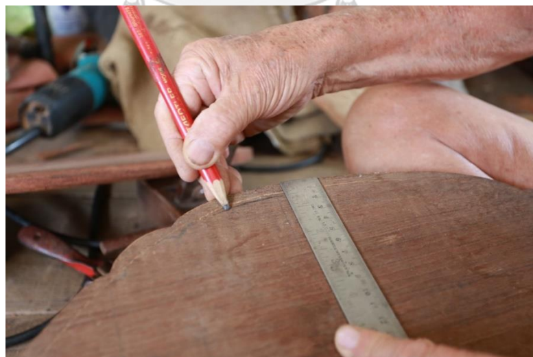
ภาพที่ 4.38 ครูชลอ ใจชื่น ใช้ไม้บรรทัดวัดโขนขนาดเอกและใช้ดินสอขีดเส้น ที่มา : วุฒิพงศ์ เถาลัดดา บันทึกภาพวันที่ 26 เมษายน 2561
