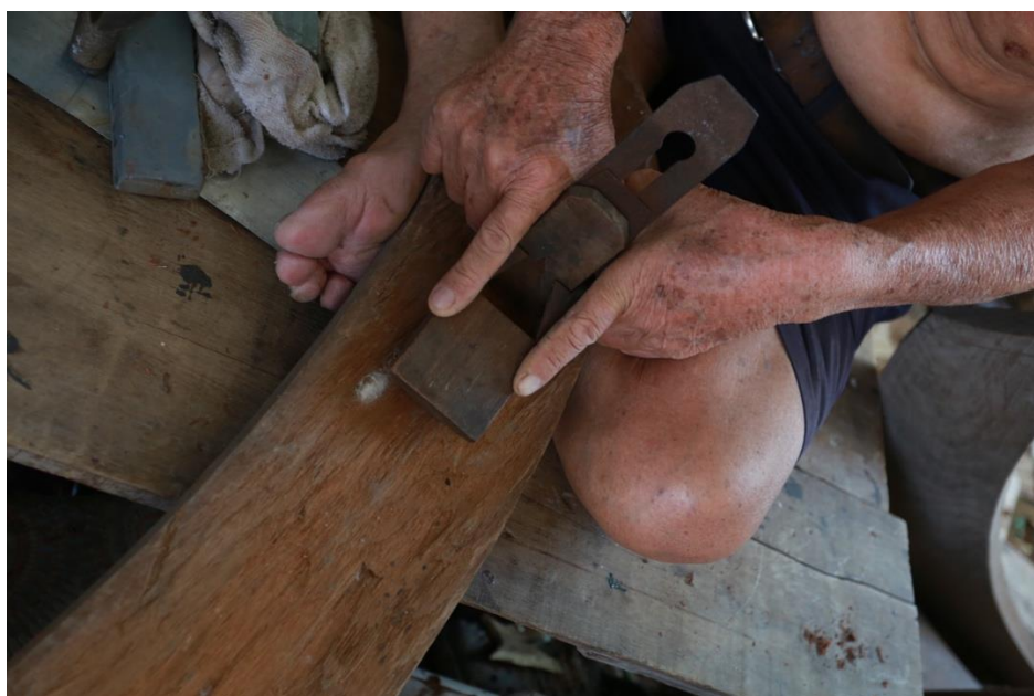
ภาพที่ 4.46 ครูชลอ ใจชื่น ใช้กบไสไม้แต่งรางระนาดเอก ที่มา : วุฒิพงศ์ เถาลัดดา บันทึกภาพวันที่ 12 พฤษภาคม 2561
