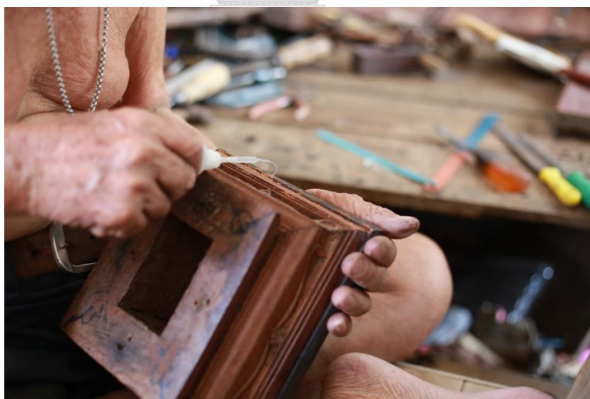
ภาพที่ 4.78 ครูชลอ ใจชื่น ใช้ขี้เลื่อยใส่และใช้กาวร้อนใส่เพื่อแต่งทำระนาดเอก
