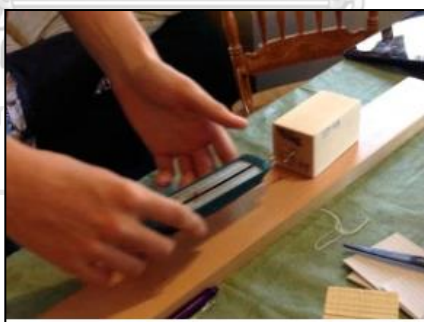
ภาพที่ 2. 14 การวัดแรงเสียดทานจากวิธีสปริง (homeschoolsciencegeek.wordpress.com 2015)
