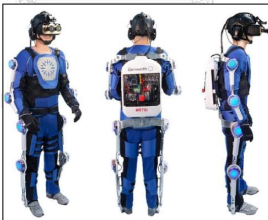
ภาพที่ 2. 9 ชุดจำลองความสูงอายุ Genworth R70i Aging Experience (H.L. Groza 2016)
