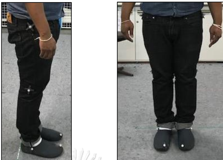
ภาพที่ 3. 28 ตำแหน่งลูกบอลบนร่างกายของผู้เข้าร่วมทดลอง ไม่สวมข้อต่อแรงเสียดทานต้นแบบ - เดินโดยสวมข้อต่อแรงเสียดทานต้นแบบ ติดลูกบอลวางแสงบนร่างกายด้วยเวลโกรเทป หลังจากใส่อุปกรณ์เข้าต้นแบบสร้างแรงเสียดทานจำลองความชรา ทั้งหมด 10 ตำแหน่ง ได้แก่ สะโพก ด้านซ้ายและด้านขวา แขนมาร์กเกอร์ด้วย L1 และ R1, เทนือเข้าซ้ายและเข้าขวา แขนมาร์กเกอร์ด้วย L2 และ R2, ใต้เข้าซ้ายและเข้าขวา แขนมาร์กเกอร์ด้วย L3 และ R3, ส้นเท้าซ้ายและส้นเท้าขวา แขนมาร์กเกอร์ด้วย L4 และ R4, นิ้วโป้งเท้าซ้ายและนิ้วโป้งเท้าขวา แขนมาร์กเกอร์ด้วย L5 และ R5
