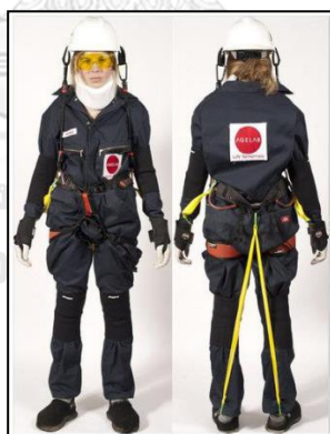
ภาพที่ 2. 7 ชุดจำลองความสูงอายุ AGNES suit ของ MIT (H.L. Groza 2016)
