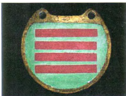
ภาพที่ 9 แสดงส่วนผสมที่อัดเข้าไปในภาชนะหล่อแบบส่วนครึ่งล่าง และตัดส่วนเกินออก
