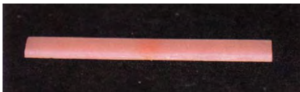
ภาพที่ 19 แสดงชิ้นงานอะคริลิกเรซินที่ซ่อมแซม และขัดแต่งแล้ว
