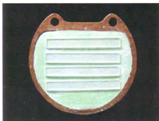
ภาพที่ 8 แสดงการนำแม่แบบแผ่นพลาสติกใสวางลงในภาชนะหล่อแบบพื้นปดอมทองเหลือง
