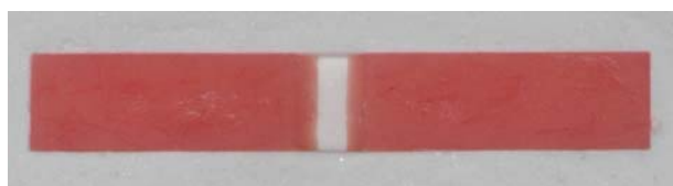
ภาพที่ 17 แสดงชิ้นงานอะคริลิกเรซินที่นำมากรอดัดก่อนนำไปทำการซ่อมแซม ใส่กลับลงแม่แบบที่ทำด้วยพลาสติกออปทาร์ส
