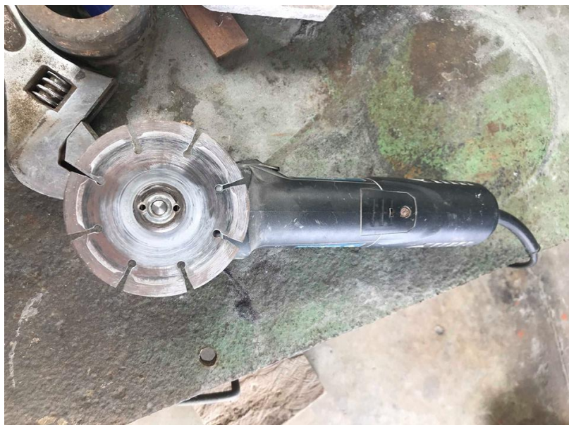
ภาพที่ 89 เครื่องเจียรหินสำหรับแต่งเสียง ที่มา: สรายุทธ ไซดิรัตน์, 26 เมษายน 2562
