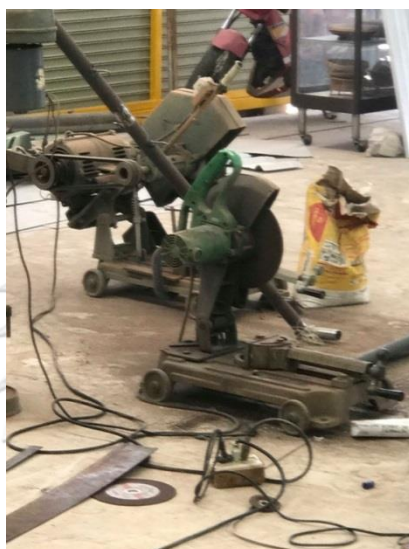
ภาพที่ 87 เครื่องตัดเหล็กสำหรับตัดทำราวแขวนระฆังหิน
