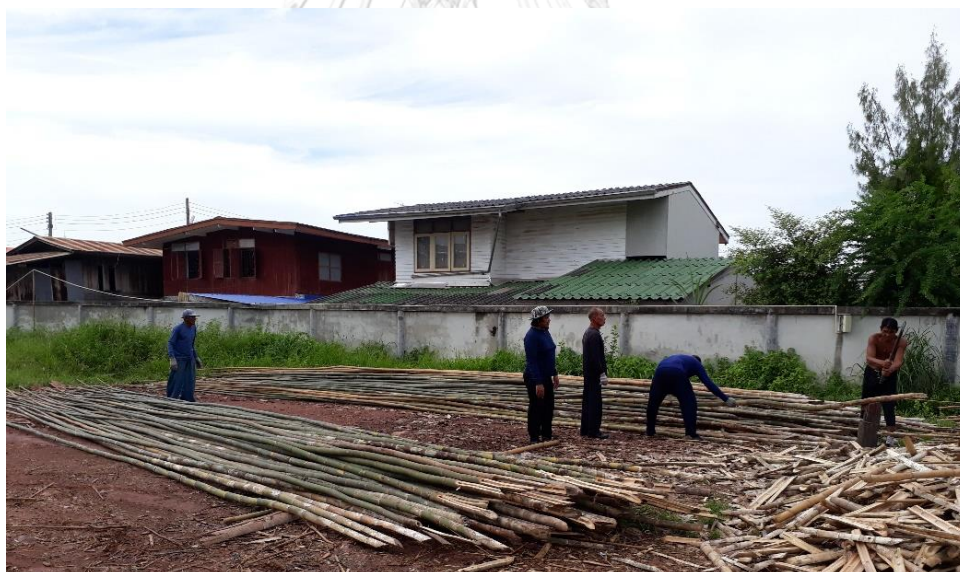
ภาพที่ 66 กลุ่มคนงานกำลังตัดโค่นไม้รวกให้แหลมเพื่อเตรียมนำไปปักซ่อมปักโป๊ะ
