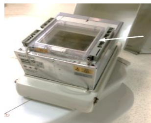
ภาพที่ 5 แสดงตำแหน่งเครื่องแดพมิเตอร์ (KAP meter) ที่ติดตั้งตลอดเอกซเรย์ (ลูกศร)
