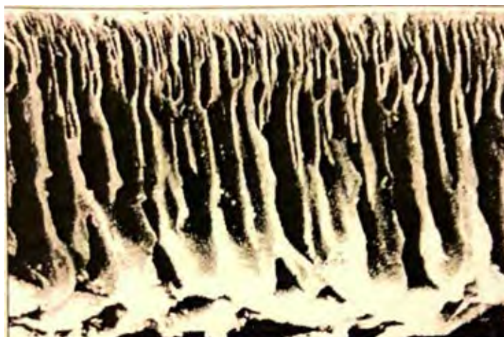
รูปที่ 1 ภาพตัดขวาง SEM ของเมมเบรนอัลตราฟิลเตรชันแอนไอโซทรอปี
