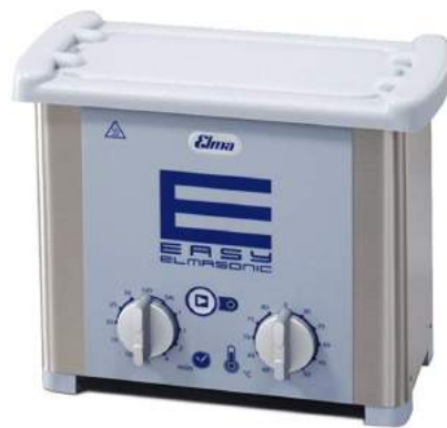
รูปที่ 3.3 : เครื่องสั่นอัลตราโซนิก ยี่ห้อ Elma รุ่น ELMA-EASY-30H
