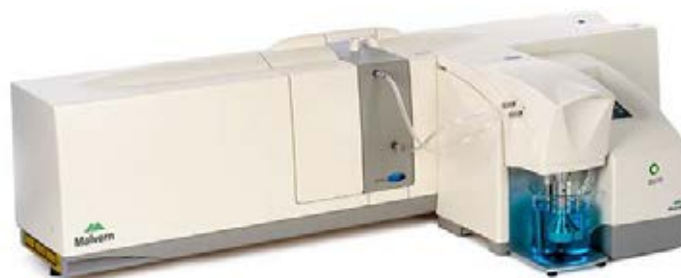
รูปที่ 3.5 : เครื่องวิเคราะห์ขนาดอนุภาค ยี่ห้อ Malvern รุ่น Mastersizer 2000
