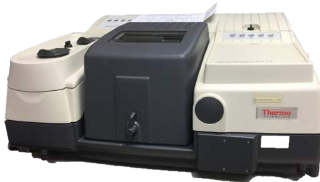
รูปที่ 3.7 : เครื่องวิเคราะห์ด้วยเทคนิคฟูเรียร์ทรานส์ฟอร์มอินฟราเรดสเปกโทรสโคปี ยี่ห้อ Thermo Scientific รุ่น Nicolet
