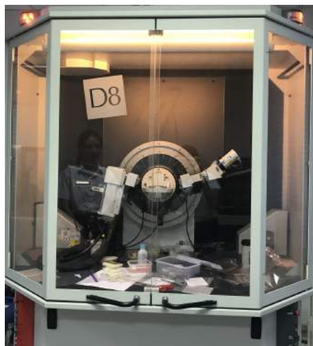
รูปที่ 3.8 : เครื่องวิเคราะห์การเลี้ยวเบนรังสีเอ็กซ์ ยี่ห้อ Karlsruhe รุ่น Bruker-AXS D8
