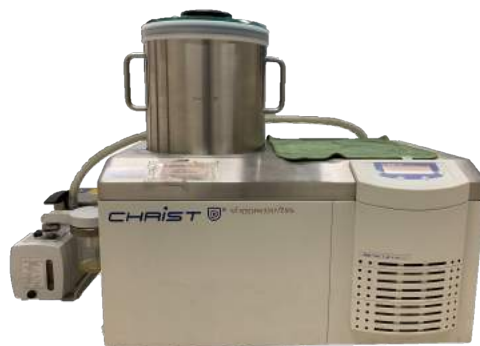
รูปที่ 3.4 : เครื่องทำแห้งแบบแช่เยือกแข็ง ยี่ห้อ CHRIST รุ่น Beta 1-8 LSCplus
