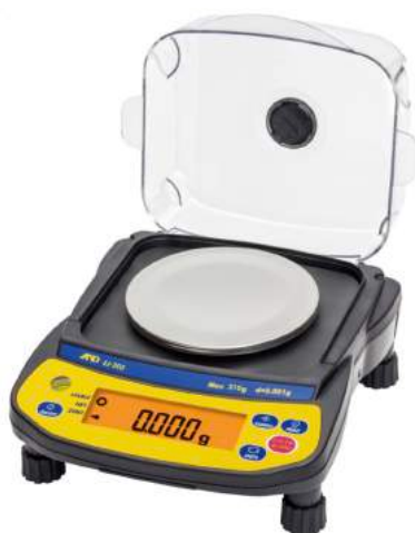
รูปที่ 3.1 : เครื่องชั่งสารเคมี ยี่ห้อ AND รุ่น EJ-303 Newton Series Compact Balance 310 g x 0.001g
