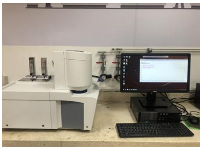
รูปที่ 3.2 เครื่องวัดการเปลี่ยนแปลงขนาดของวัสดุเมื่อได้รับความร้อน
