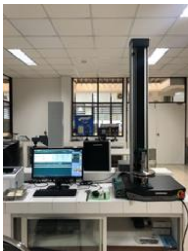
รูปที่ 3.1 เครื่องทดสอบอเนกประสงค์ (Universal testing machine) ของบริษัท LLOYD รุ่น Tinius Olsen
