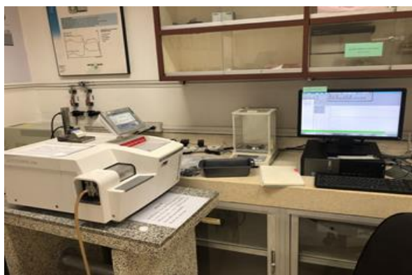
รูปที่ 3.3 Thermogravimetric Analyzer, TGA ของบริษัท Mettler Toledo รุ่น TGA/DSC 3
