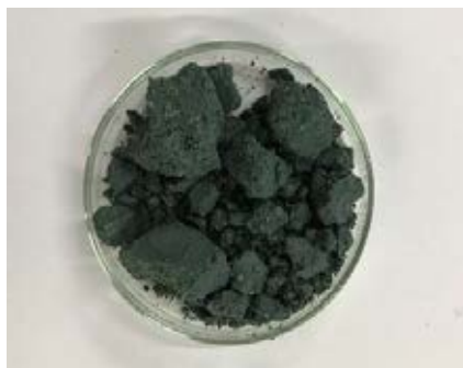
ภาพที่ 2.5 ลักษณะของกากตะกอนโครเมียมจากน้ำยาชุบโครเมียม
