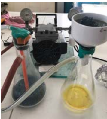
ภาพที่ 3.1 การกรองกากตะกอนโครเมียมจากน้ำยาชุบโครเมียมหลังการล้าง
