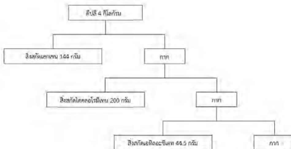
แผนภาพที่ 2.1 ขั้นตอนการสกัดผลดีป्लीด้วยเฮกเซน ไดคลอโรมีเทน และเอทิลอะซิเตท
