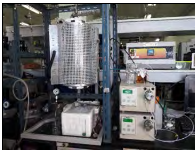
รูปที่ 3.1 ชุดเครื่องปฏิกรณ์แบบเบตนิ่งสำหรับงานวิจัย
