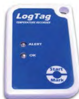
ภาพที่ 3-10 การเก็บข้อมูลอุณหภูมิอากาศและความชื้นสัมพัทธ์ด้วย Data logger ในแปลงถาวร
