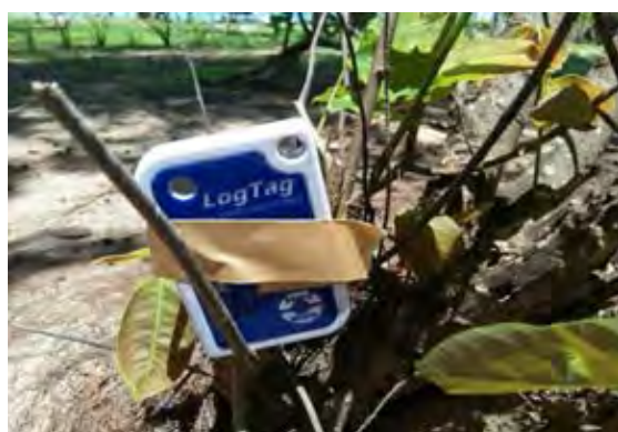
ภาพที่ 3-10 การเก็บข้อมูลอุณหภูมิอากาศและความชื้นสัมพัทธ์ด้วย Data logger ในแปลงถาวร
