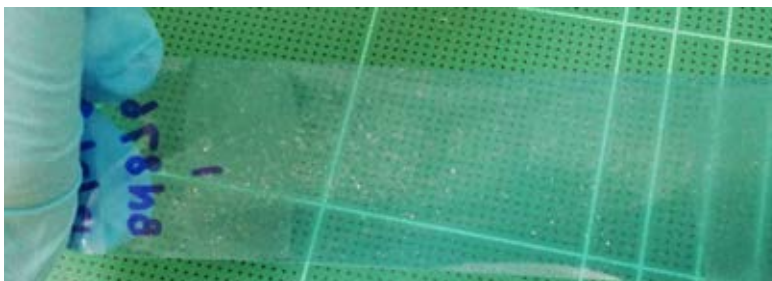
รูปที่ 20 เศษ BN ที่กระจายอยู่บนเทป
