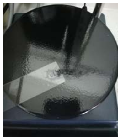
รูปที่ 21 (บน) PDMS mold ที่อยู่แปะเทปใสอยู่บน glass slide (ล่างซ้าย) เครื่องสปินในการสปิน PPC (ล่างขวา) hot plate สำหรับให้ความร้อนแก่ PPC
