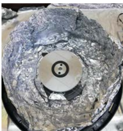
รูปที่ 21 (บน) PDMS mold ที่อยู่แปะเทปใสอยู่บน glass slide (ล่างซ้าย) เครื่องสปินในการสปิน PPC (ล่างขวา) hot plate สำหรับให้ความร้อนแก่ PPC
