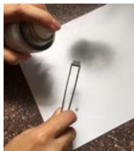
รูปที่ 3.7 ฟันสเปรย์แกรไฟต์เคลือบชิ้นสารให้ทั่วทั้งชิ้น
