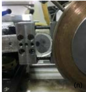
รูปที่ 3.6 (ก) ตัดชิ้นสารตามแนวขวางของชิ้นสาร (ข) สารที่ตัดจนมีขนาด 1x1cm
