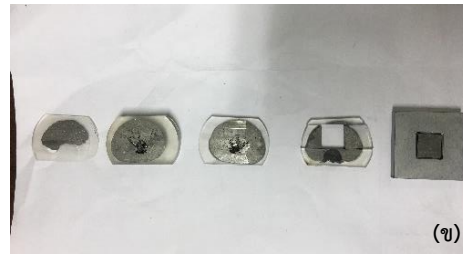
รูปที่ 3.6 (ก) ตัดชิ้นสารตามแนวขวางของชิ้นสาร (ข) สารที่ตัดจนมีขนาด 1x1cm
