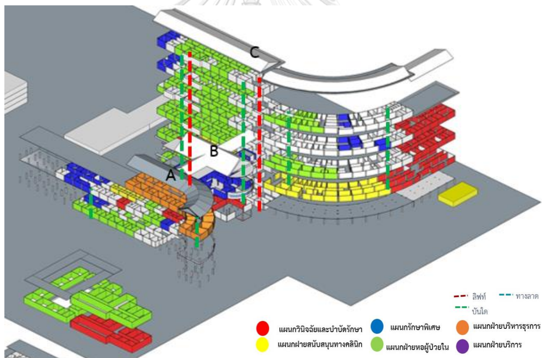
ภาพที่ 4.20 การแบ่งอาคารตามพื้นที่ใช้สอยของโรงพยาบาล
