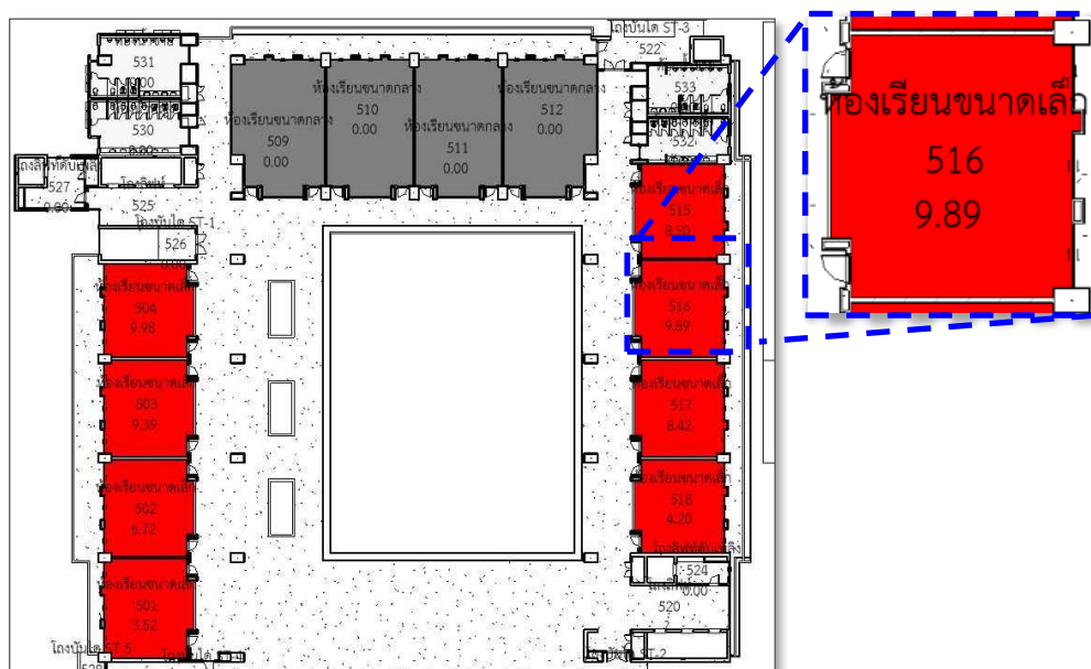
ภาพที่ 4. 16 การแสดงผลการประเมินในรูปแบบแปลนบนแบบจำลองสารสนเทศอาคาร
