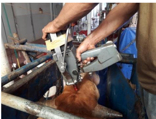
รูปภาพที่ 3 : วิธีการยิงเพื่อทำให้โคสลบและลักษณะปืนยิงสลบ
