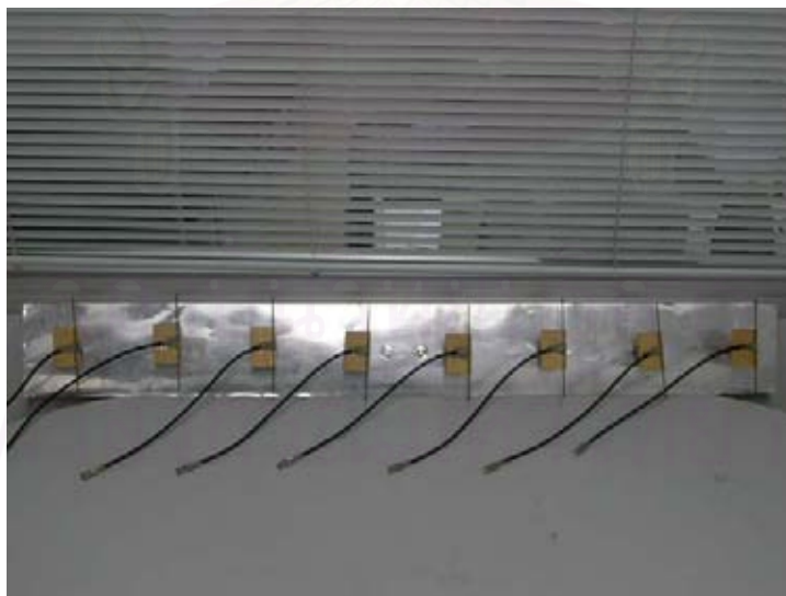
รูป 4.1 สายอากาศแถวลำดับที่มีองค์ประกอบเป็นสายอากาศขั้วคู่จำนวน 8 องค์ประกอบทำงานที่ความถี่ 1 GHz วางอยู่บนระนาบดินขนาดเล็ก และป้อนกำลังด้วยสายส่งแบบแกนร่วม
