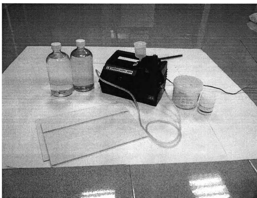
รูปที่ 3.9 อุปกรณ์และวัตถุดิบในการเคลือบสารเรืองรังสีเอกซ์บนแผ่นกระจก
